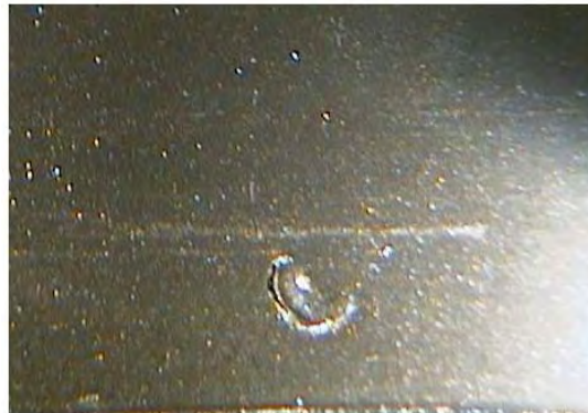
Aspetto di superficie con truciolo
