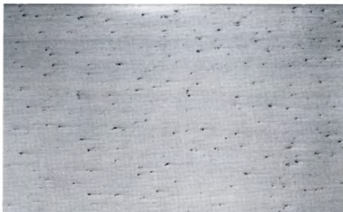
Aspetto della superficie precedente dopo spazzolatura "spinta".
