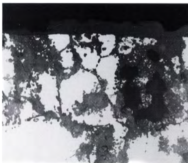
Superficie come in 10, con evidenza di una efflorescenza manifestatasi dopo un certo periodo dall'anodizzazione.
